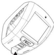
カメラの角度調節器を開いて、内側のギアを回して水平ラインと地平線が重なるように調節ください。
