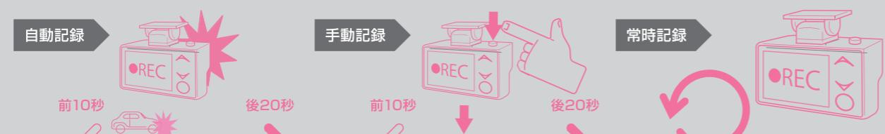
万が一の事故時には、衝撃を本体内蔵のセンサーが検知して、その衝撃の前10秒/後20秒(計30秒)の映像を自動で記録します。
