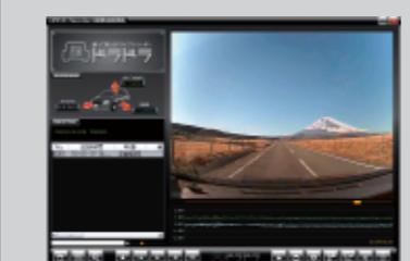
ドラドラ DD-03には、PC専用ソフトウェア「ドラドラ・マネージャー」が付属しています。日時順での映像再生、映像が記録されたときの加速度データの確認、各種設定が可能です。家でゆっくりと動画を観たいときなどにご活用いただけます。
